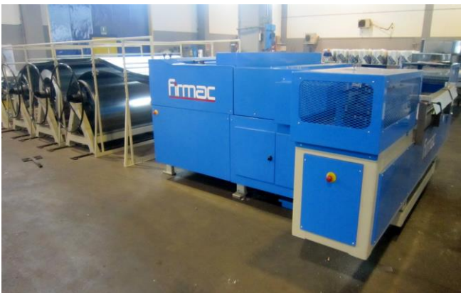
LINEA DI PRODUZIONE CANALI DRITTI STANDARD, COMPLETA DI MACCHINA PER CHIUSURA AUTOMATICA E CARICATORE PER LAMIERE DA COIL . CANALI DRITTI STANDARD CON LUNGHEZZE 1340mm o 1380mm COMPLETI DI FLANGE RICAVATE DA LAMIERE
