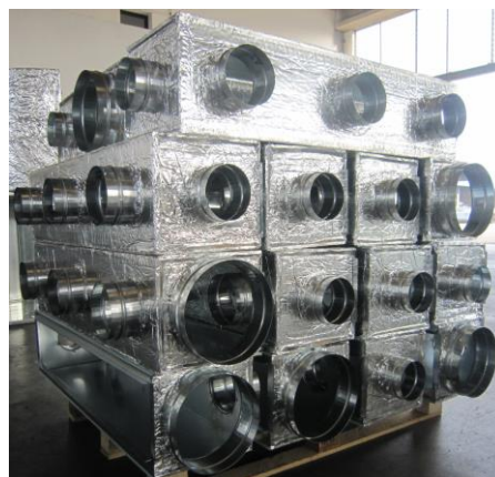
Plenum isolati esternamente
