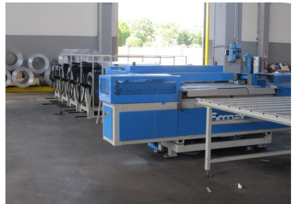
LINEA DI PRODUZIONE CANALI DRITTI STANDARD, COMPLETA DI MACCHINA PER CHIUSURA AUTOMATICA E CARICATORE PER LAMIERE DA COIL . CANALI DRITTI STANDARD CON LUNGHEZZE 1340mm o 1380mm COMPLETI DI FLANGE RICAVATE DA LAMIERE
